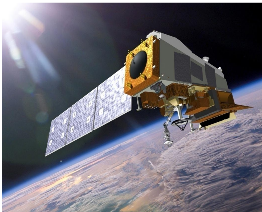
1.6 Сурет – Suomi NPP жер серігі бортындағы аппаратура
